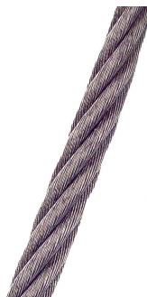
CABLE MONOTRON Cable monotron 1 x 19 fils en inox A 316, diamètre 2.5 mm, prix au mètre. Réf. : 203 15 37
